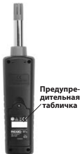
Рисунок 2 – Тильная сторона измерителя температуры и влажности micro HM-100
