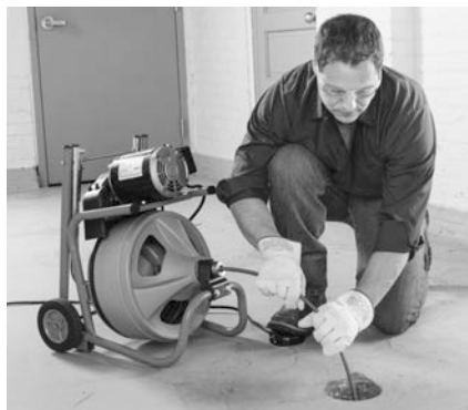
Рис. 13 – В рабочем положении, ручная подача троса
