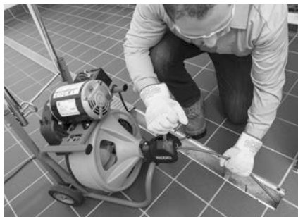
Рис. 15 – Эксплуатация модели К-400 с механизмом автоподдачи AUTOFEED
