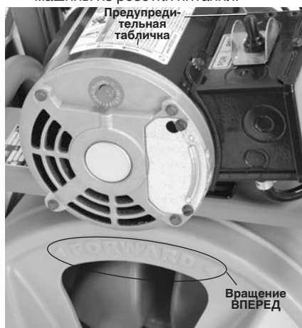
Рис. 8 – Надлежащее вращение барабана (Положение переключателя ВПЕРЕД )
