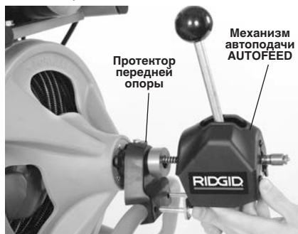
Рис. 5 – Монтаж механизма автоподачи AUTOFEED на раме
