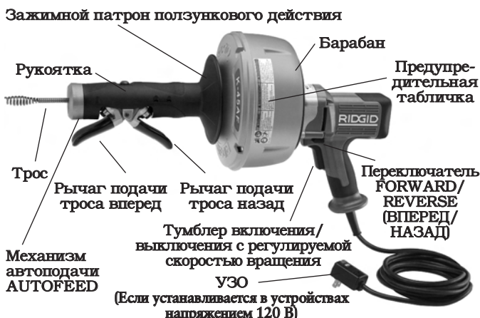
Рис. 2 – Инструмент для чистки канализации К-45 AF с автоподачей AUTOFEED
