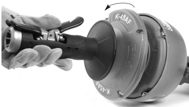
Рис. 14 – Проверните и отделите крышки барабана
