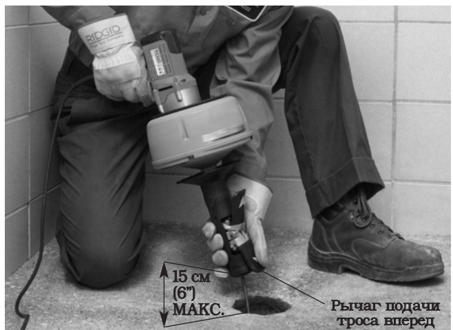
Рис. 10 – Автоматическая подача троса в режиме AUTOFEED
